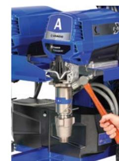
1. Sicherungsmutter lösen
