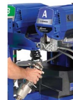
3. Schlauch entfernen und Pumpe herauschieben
